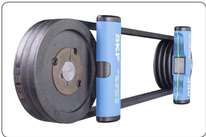
Рисунок 4 Блоки, установленные на шкивы
