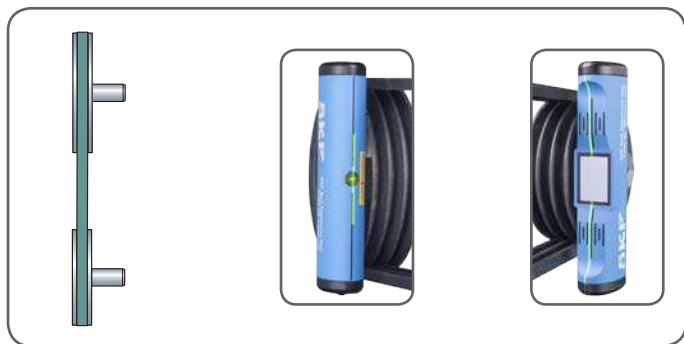
Figure 9 Poulies parfaitement alignées
